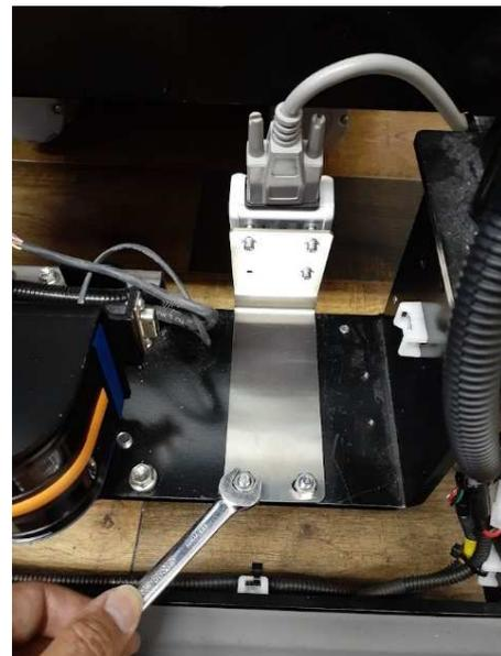
①交差点制御(QR)の機器をキーカートに取付ける説明をします。
