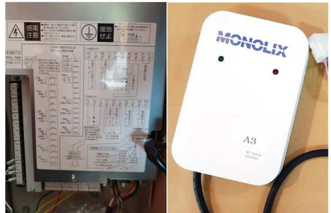
KEY×CONのキーカート搭載機と同サイズのシャッター制御機をシャッター制御盤に接続する。
